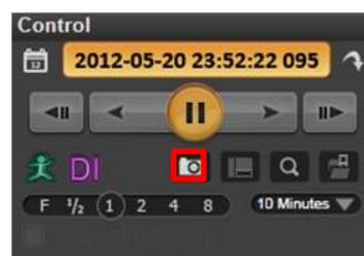
ライブ ビュー画面でチャンネルのライブ映像のスナップショットを撮影できます。スナップショットはクライアント コンピュータのデフォルトのフォルダーに .jpg 形式で保存されます (システムによるデフォルトの場所は **Windows デスクトップ**となっています)。スナップショット撮影後、NVR ウィンドウの下部に保存場所のパスが表示されます。
